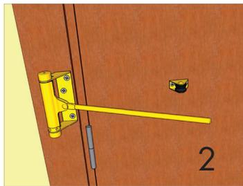
Dopo aver indossato adeguati strumenti di protezione per occhi e mani, far girare l'asta del chiudiporta il più possibile verso il muro per evitare intralci o pericoli e avvitare la rotella di scorrimento alla porta.
